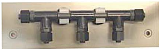
Vakuové sběrné potrubí s uzavíracím kohoutem
